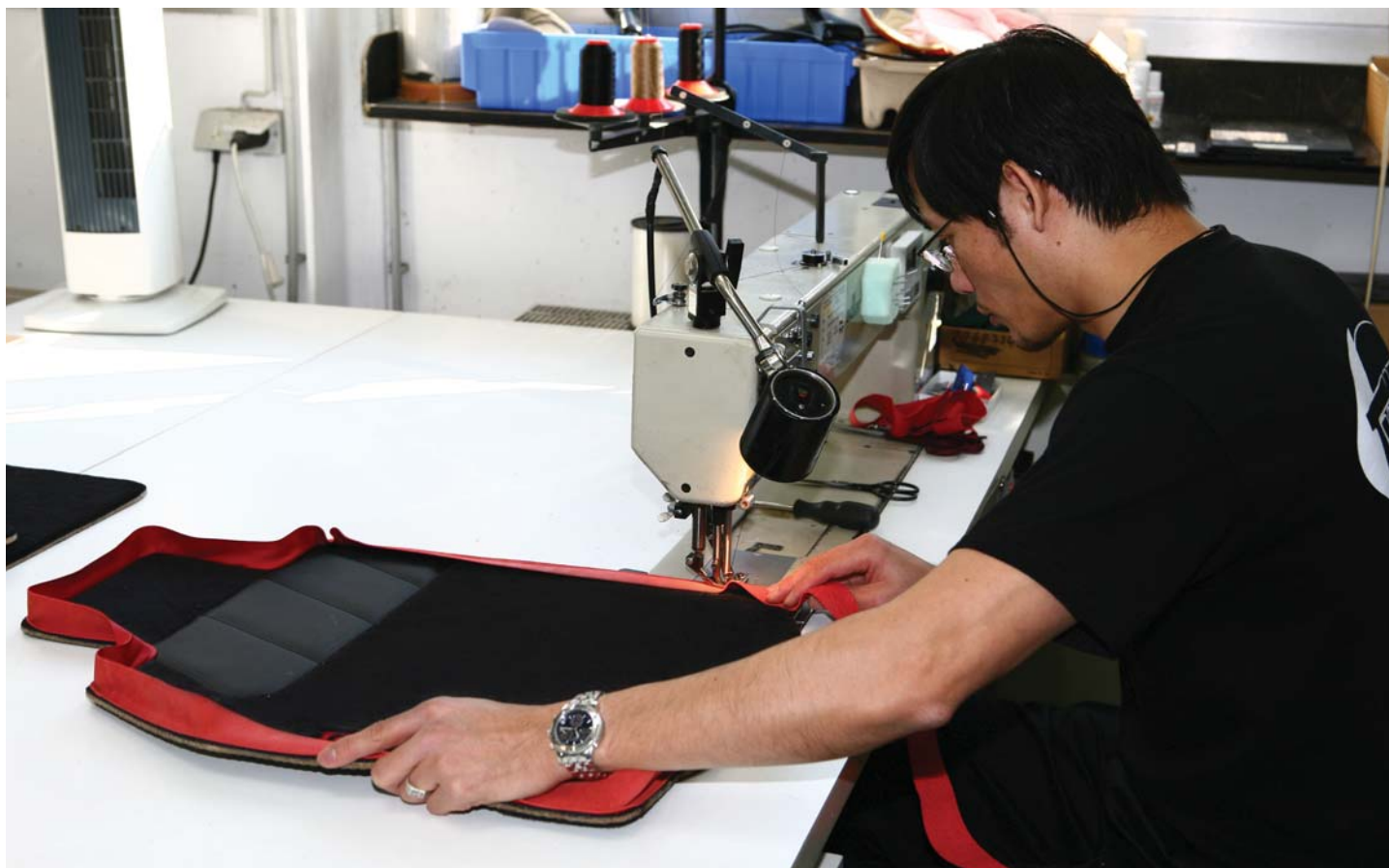
TECHART Fußmatten werden in Handarbeit gefertigt. Im Bild: die Herstellung der Ledereinfassung in Individualfarbe TECHART floor mats are handcrafted. This picture shows the making of the custom-colored leather piping
