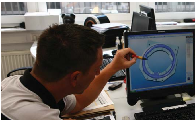
Entwicklung von Gusswerkzeugen für die ergonomisch geformten TECHART Sportlenkräder Design of the casting molds for the ergonomically shaped TECHART sports steering wheels
